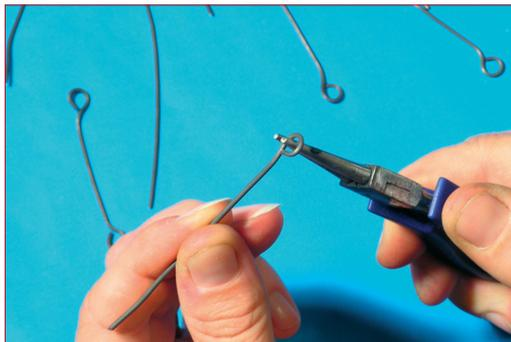
Z kousků drátu si kuželovitými kleštěmi vyrobte hodně spojek různých velikostí.
