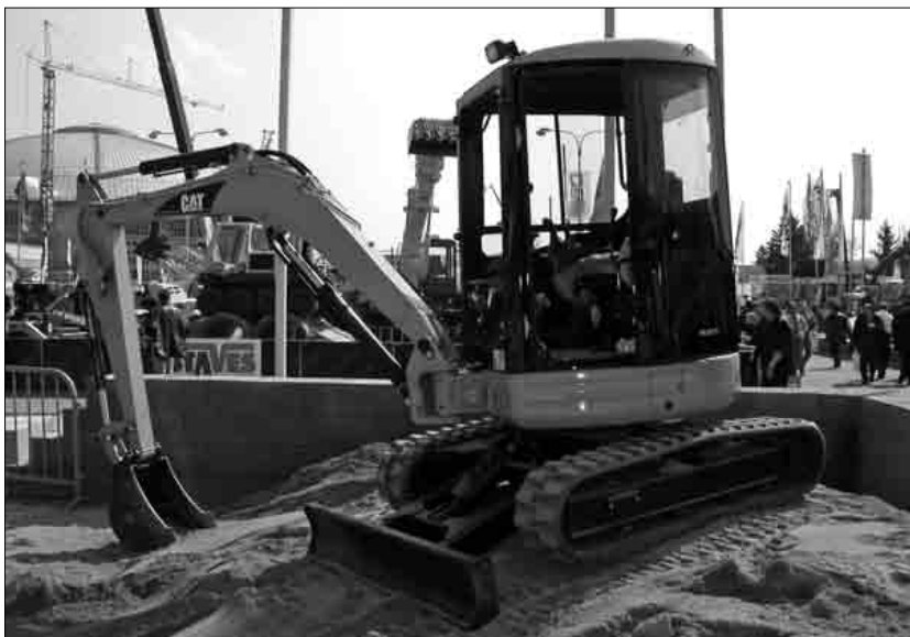
Minibagr pro hloubení kanalizace a úzké základové pásy
