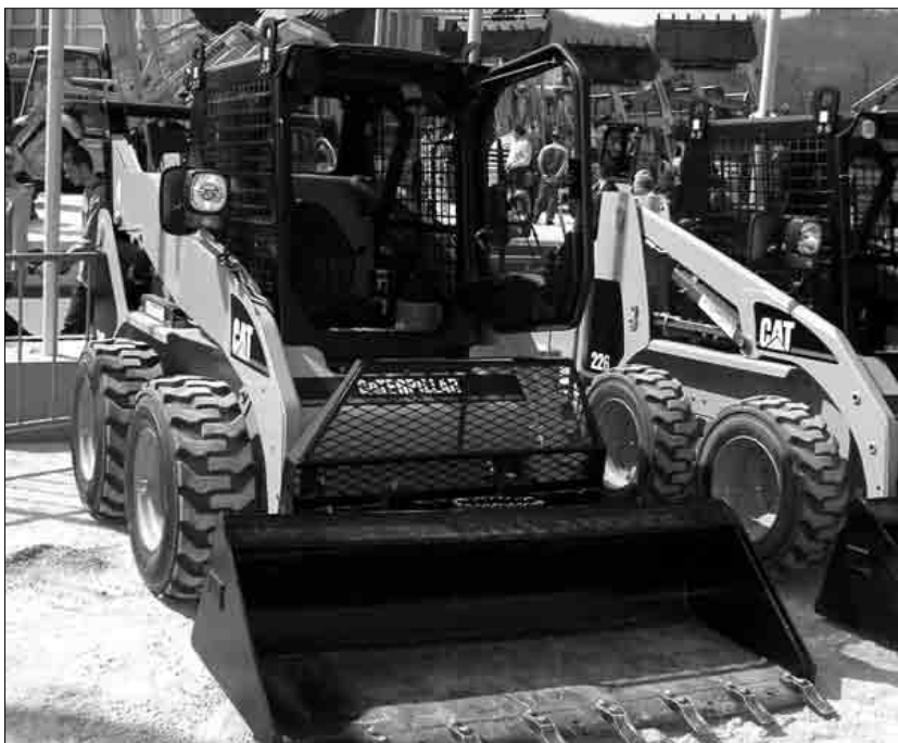
Malý nakladač pro finální terénní úpravy a převoz materiálu v omezeném prostoru
