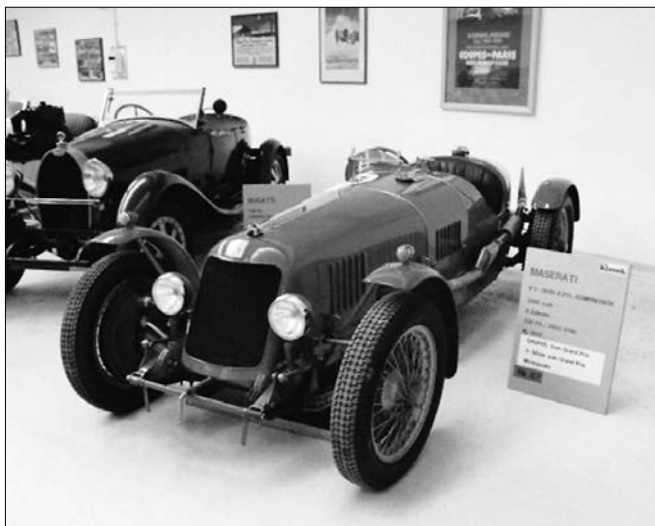
Maserati 8C 3000 - byl vyráběn v roce 1932 a 1933. Vůz je poháněn přeplňovaným třílitrovým osmiválcem o výkonu 146 kW a dosahoval rychlosti 240 km/h
