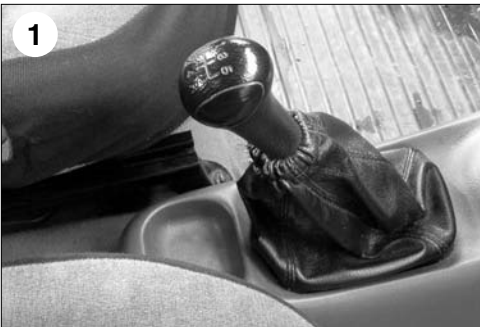
Dva nejčastější způsoby řazení zpětného chodu: 1 – vpravo dozadu, 2– vlevo vpředupřezatlačení řadicí páky směrem dolů
