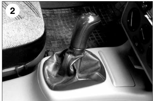
Dva nejčastější způsoby řazení zpětného chodu: 1 – vpravo dozadu, 2– vlevo vpředupřezatlačení řadicí páky směrem dolů
