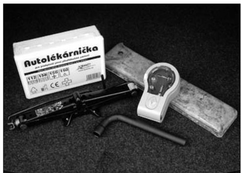
Povinná výbava vozidla – zvedák, klíč na kola, pojistky se žárovkami (1 ks od každého použitého druhu vnějšího osvětlení), výstražný trojúhelník, lékárnička... chybí už jen rezervní kolo.
