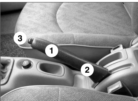
Ruční brzda a její ovládání: 1 – úchopová část páky ruční brzdy; 2 – páka ruční brzdy; 3 – pojistka ruční brzdy, před odbrzděním je nutné zatáhnout páku brzdy nahoru a současně stlačit pojistku, po celou dobu pohybu páky dolů je nutné držet stisknutou pojistku
