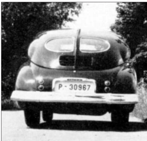
Motor T 603 zabudovaný v Tatře 87 si vyžádal změnu tvarování zadní kapoty
