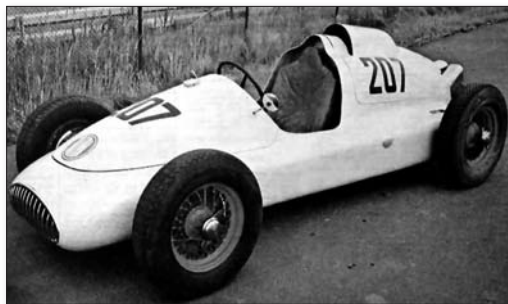
Monopost Tatra 607 byl pojízdnou laboratoří na zkoušení motorů T 603
