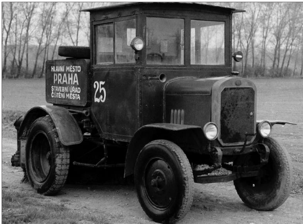
Zametací vůz BD s rotačním smetákem z roku 1923 měl pracovní rychlost 3 km/h
