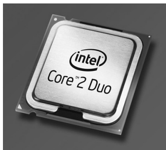
Obrázek 7.51: Processor Core 2 Duo používá patici LGA 775 a velmi přesně nastaveného napětí jádra, což vyžaduje pořízení zcela nové základní desky
