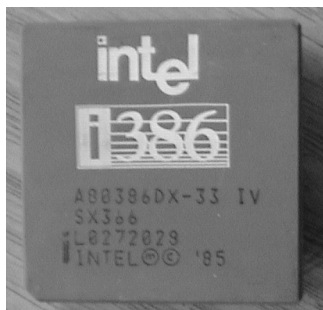
Obrázek 7.1: Procesor i386 odstartoval rozvoj architektury IA-32, což je architektura, která i přes prodělaná rozšíření patří k jedné z nejpoužívanějších
