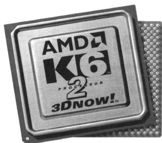
Obrázek 7.17: Procesor K6-2 je prvním procesorem, který využívá systémovou sběrnici taktovanou na 100 MHz
