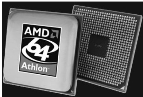
Obrázek 7.81: Athlon 64 byl prvním 64bitovým procesorem pro desktopové počítače
