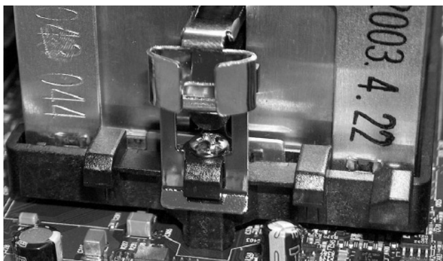
Obrázek 7.97: Správně připojená část kovové sponky
