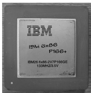
Obrázek 7.14: Procesory Cyrix kompatibilní s Pentiem vyráběla firma IBM, a proto se prodávaly i pod značkou této firmy
