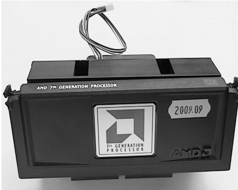
Obrázek 7.62: Athlon (na obrázku s nainstalovaným chladičem) měl velmi podobné pouzdro jako Pentium II
