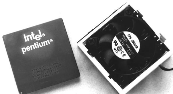
Obrázek 7.9: Procesor Pentium – na tomto obrázku je typ s taktovací frekvencí 133 MHz. Byl to první procesor, který potřeboval pro své chlazení chladič s větráčkem.
