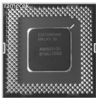
Obrázek 7.22: Před instalací chladiče je nutno umístit pod procesor umělohmotný rámeček, který umělohmotné části obsahuje i na svrchní straně.
