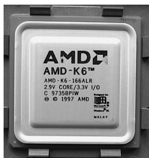
Obrázek 7.16: Procesor AMD K6 dosahoval výkonu srovnatelného s Pentiem II, přičemž používal patici Socket 7
