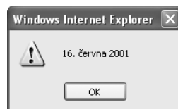
Obrázek 8.5. Objekt Date vrací řetězec s aktuálním datem, který je možné lokalizovat prostřednictvím jeho metody toLocaleDateString
