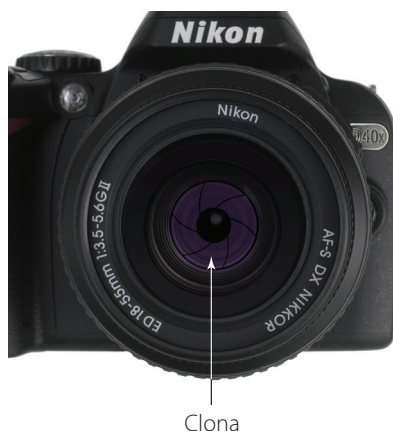
Obrázek 4.3 | Clona se otevírá a zavírá, čímž reguluje množství světla procházejícího objektivem fotoaparátu
