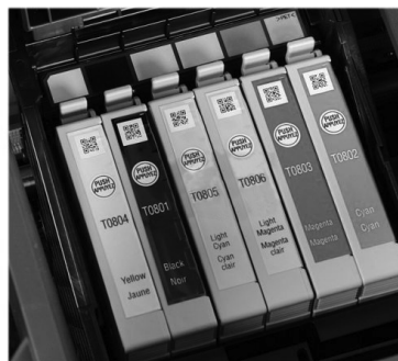
Obrázek 5.1 Vlevo je náplň s tiskovou hlavou, tiskárna vpravo má oddělené zásobníky
