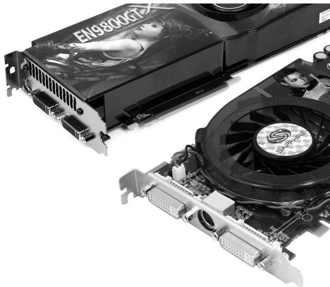
OBRAZEK 3.39: Pohled na dvouslotovou (nahore) a jednoslotovou (dole) grafickou kartu
