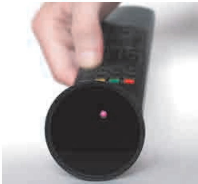
Obrázek 4.88 | Jak je vidět, infračervený filter nepropustí viditelné světlo, ale spolehlivě nechá projít infračervené záření
