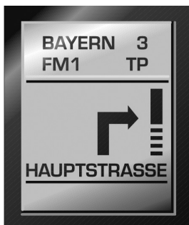
Obrázek 2.1 Starý typ navigace zabudované v palubním počítači VW Passat B5
