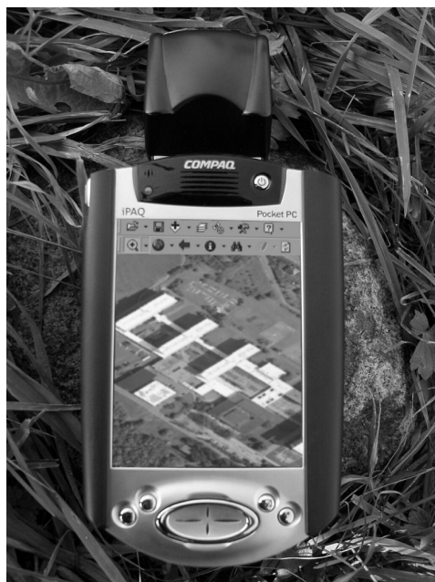
Obrázek 2.14 Modul GPS Pretec v provedení Compact Flash GPS a PDA
