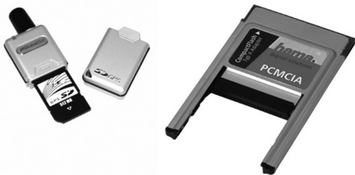
Obrázek 2.15 Modul GPS v provedení SD card (GlobalSat 502) a redukce CF/PCMCIA
