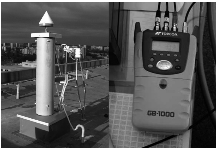
Obrázek 2.31 Referenční stanice na střeše VŠB-TU Ostrava
