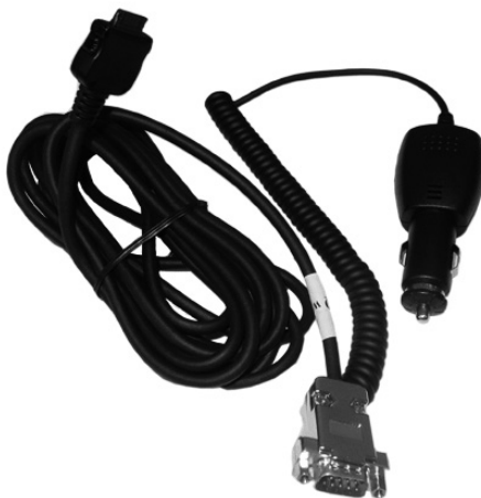
Obrázek 2.8 Sériový kabel pro připojení GPS k PDA iPAQ (Zdroj farmworks.com)
