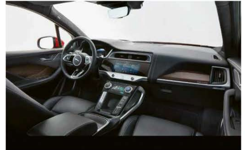
Model I-Pace nepotřeboval žádnou převodovku, tudíž i její volič byl zbytečný, což umožnilo vytvoření jiného typu středového panelu
