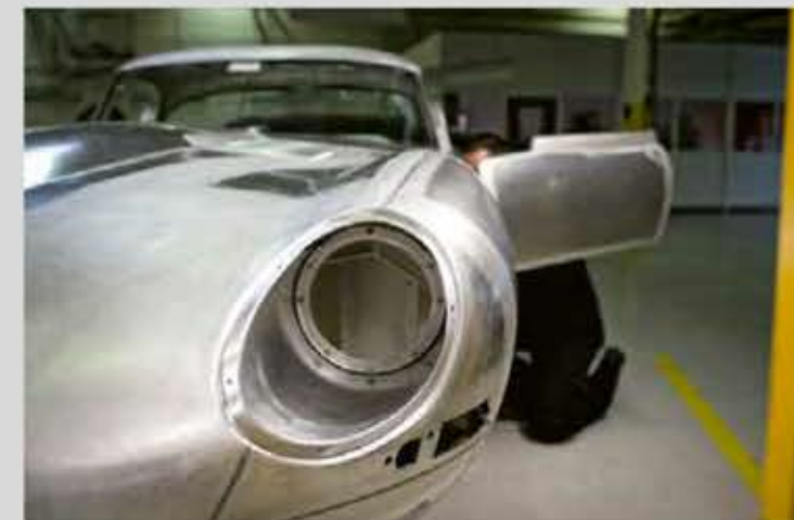
V roce 2014 se Jaguar rozhodl vrátit k minulosti tak, aby dokončil plánovanou sérii osmnácti vozů Lightweight E-Type, neboť šest z nich v 60. letech nevzniklo. Zde se formuje jedna z pečlivě vytvořených hliníkových karoserií napodobujících originál
