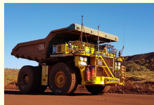
▲ Komatsu 830E vybavený systémem autonomního řízení. Tento dumper s kapacitou 231 tun se tak obejde bez řidiče.
