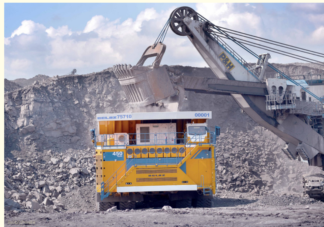
▲ Lanový bagr nakládá materiál na korbu BelAZu 75710.
