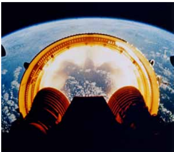
Odhodenie pomocnej konštrukcie medzi prvým a druhým stupňom. Často sú tieto zábery označované ako „Apollo 11“, ale vznikli práve pri štarte druhého Saturnu V s loďou Apollo 6 (natáčané boli na filmový pás a následne pristávali do oceána v malých moduloch)
