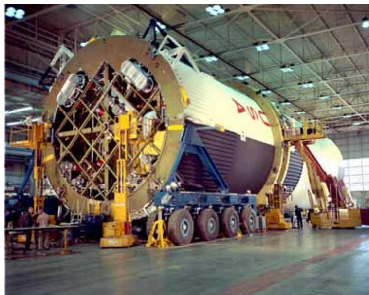
Dno prvého stupňa Saturnu V S-IC bez inštalovaných motorov odhaľuje ich uloženie: kvarteto na okrajoch je opreté pevne, stredový je umiestnený veľmi voľne na konštrukcii tvaru X
