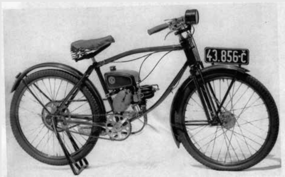
K tomu, aby vzniklo kvalitní motokolo, nestačilo jenom opatřit rám jízdního kola pohonnou jednotkou. Díky tomu měla ČZ 76 Kactus blíž k motocyklu než jízdnímu kolu.
