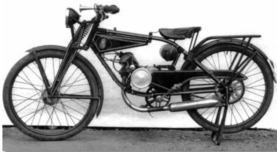
Motokolo ČZ 98 v provedení z roku 1935 s novým sedadlem motocyklového typu, přední lisovanou vidlicí a upraveným tvarem nádrže.
