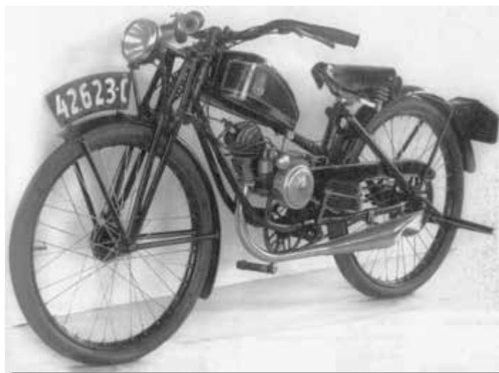
Motokolo ČZ 98 modelového roku 1934 v provedení pro dámy, ještě s prototypovou přední vidlicí a sedlem bicyklového typu.
