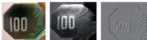
Detail kinegramu, při kolmém pohledu (vlevo); snímek pořízený s filtrem MX15 lupou MacroCam (uprostřed); profilometricky pozitivní obraz s vyznačením periferie kinegramu a nominální hodnotou bankovky v jeho těle (vpravo)
