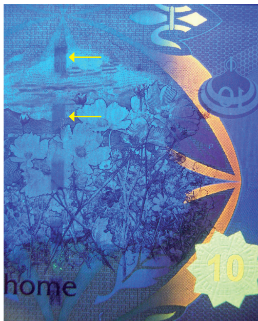
Detail bankovky v UV světle, proužek je intermitentní, tmavé články (žluté šipky), bohatá UV výbava bankovky
