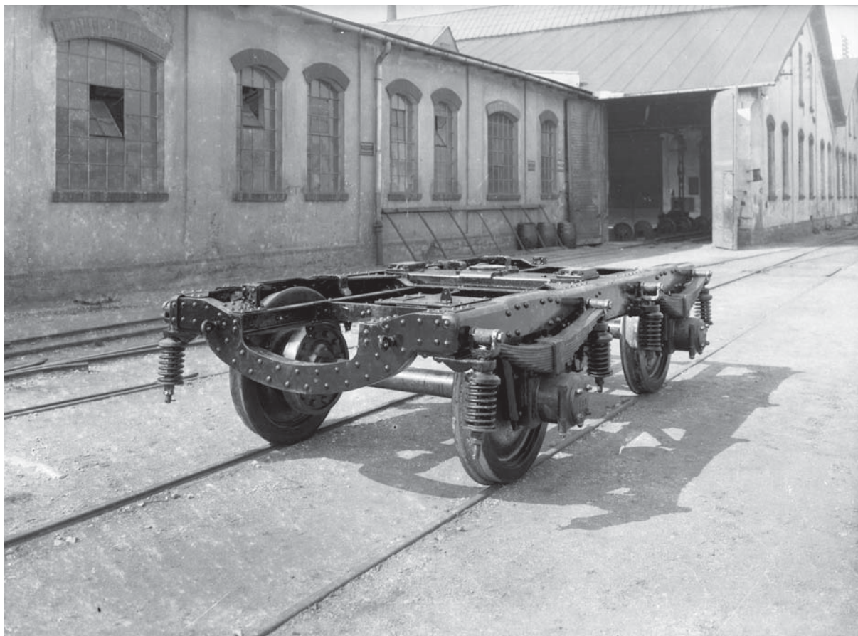
Otočný podvozek motorového vozu M230.001. Měl rozvor náprav 2,4 m.
