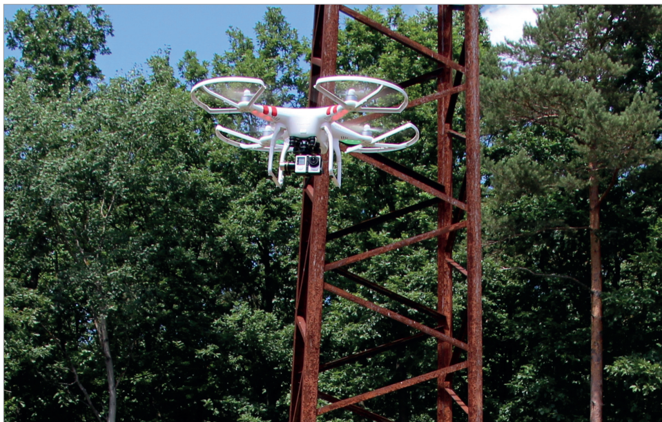
Obrázek 7.5 Kryty vrtulí jsou výbornou ochranou při létání dronu blízko různých objektů nebo v interiérech
