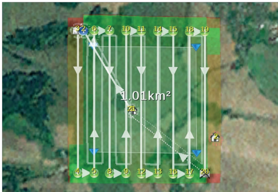
Obrázek 7.3 Příklad plošného letového plánu, kdy se dron pohybuje v řadách, aby letecké fotografie měly mezi sebou příčné i podélné překryvy
