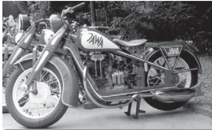
Jawa 500 OHV dostala v roce 1930 novou přední vidlici a v roce 1931 nový tlumič výfuku
