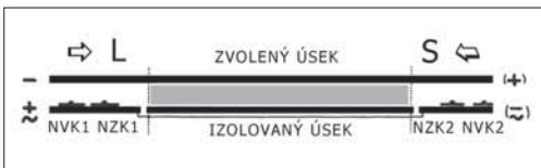
Rychlost soupravy v předem zvoleném úseku lze ovládat pomocí přepínacího relé
