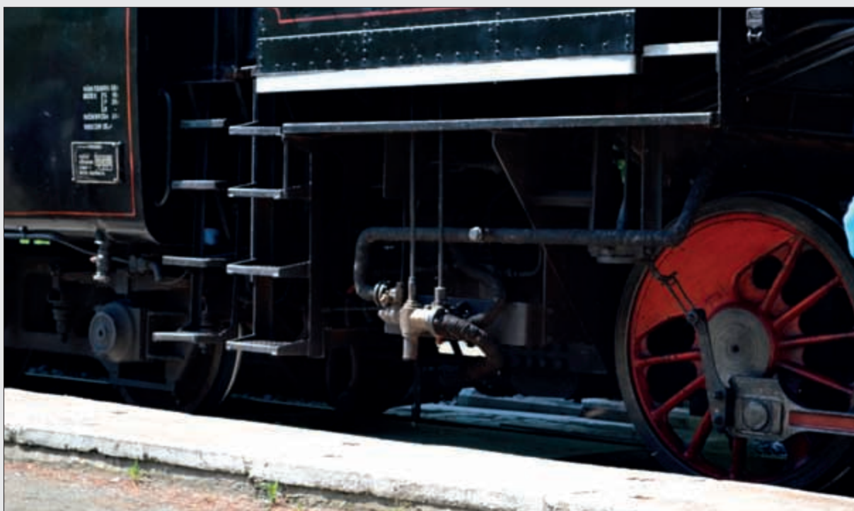
Na fotografii je nesací parní injektor. Většina parních lokomotiv ČSD měly dvě tyto armatury po jedné na každé straně. Traťové lokomotivy měly vlevo nesací napáječ na výfukovou páru.
