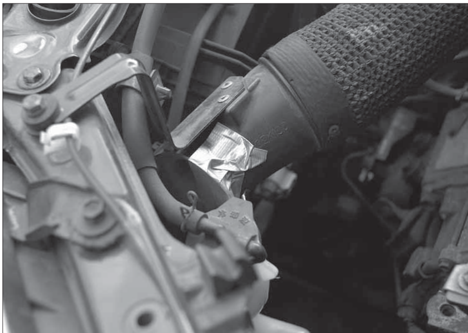
Zalepení vstupu do sání – vstupní průměr je částečně seškrccen
