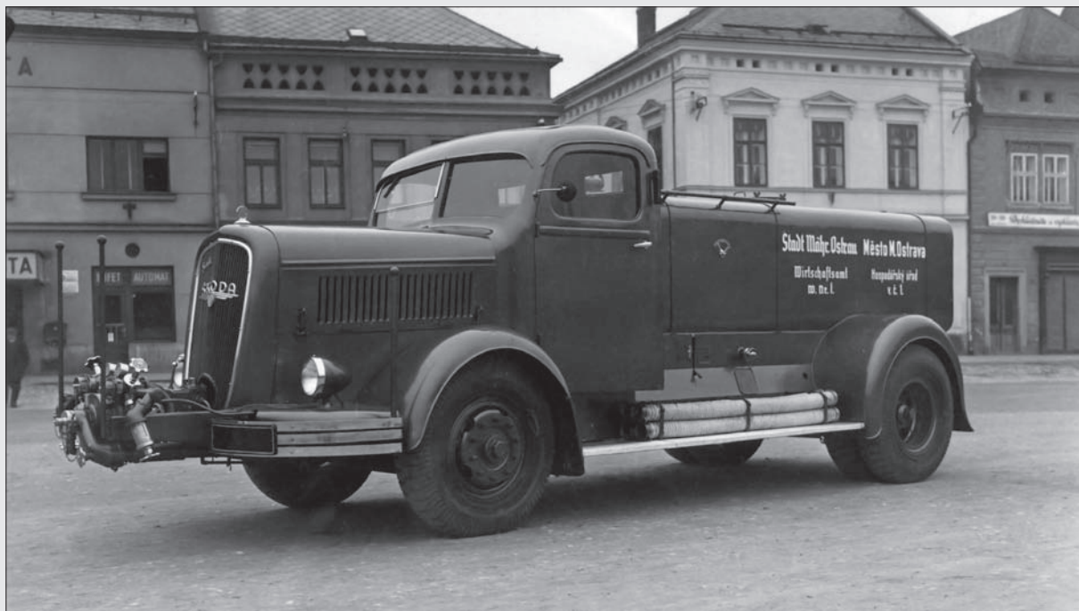
Speciální automobil na mytí a čištění komunikací na podvozku Škoda 606 D pro Moravskou Ostravu
