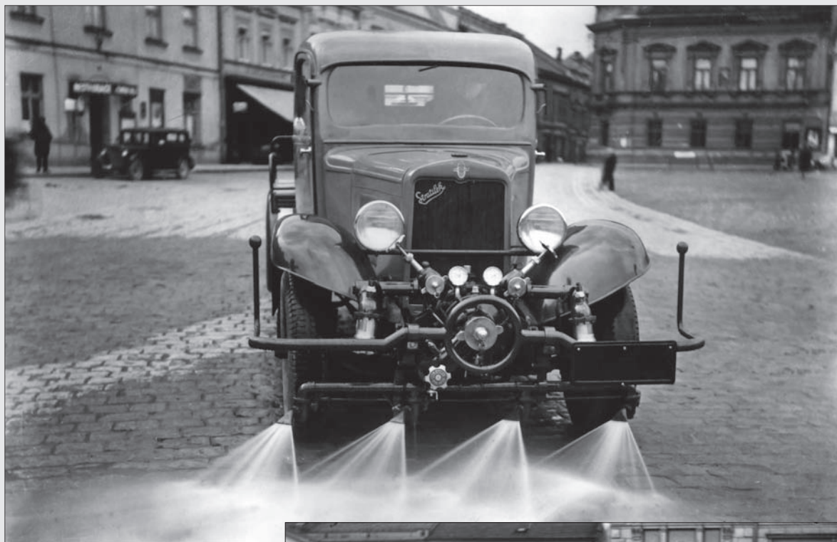
Zařízení na tlakové mytí vozovky na kombinovaném vozidle Chevrolet připravila továrna Stratílek pro Zlín.
