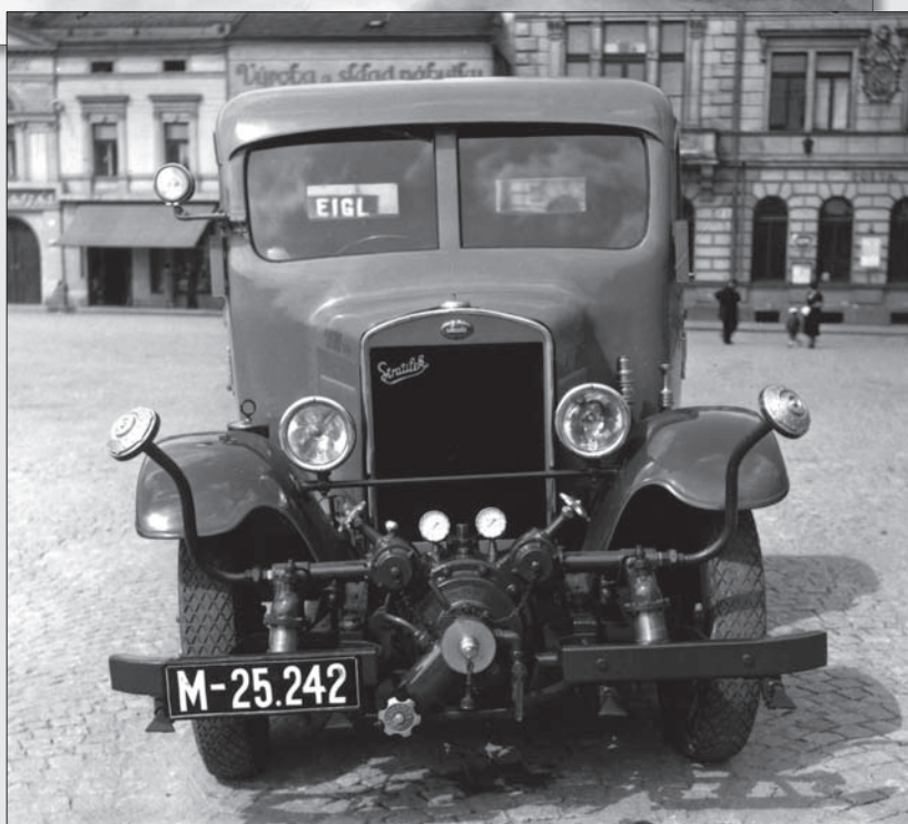
Podvozek Škoda s armaturami firmy Stratílek. Důmyslné zařízení umožňovalo vodu stříkat dopředu, na boky a prostřednictvím růžic ovlažovat ovzduší.
