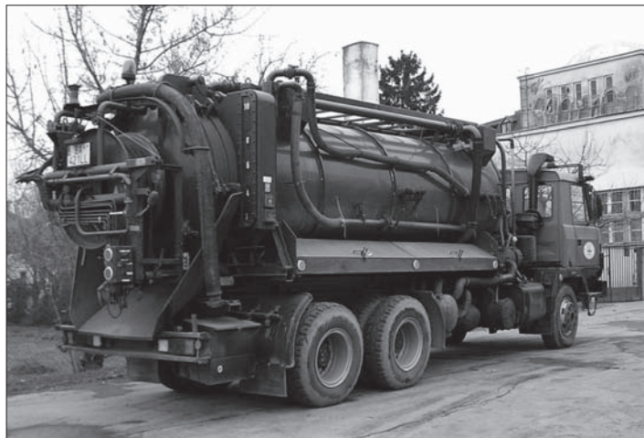
Sací automobil Tatra 815-2 6x6.2 s nástavbou německé firmy Hellmers
