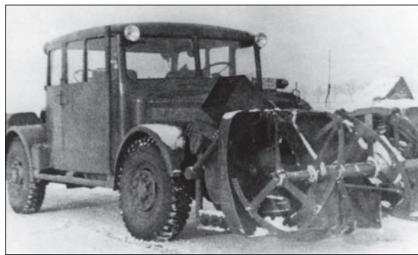
Sněhová fréza vznikla spojením dvou předních částí Tatry 111.
