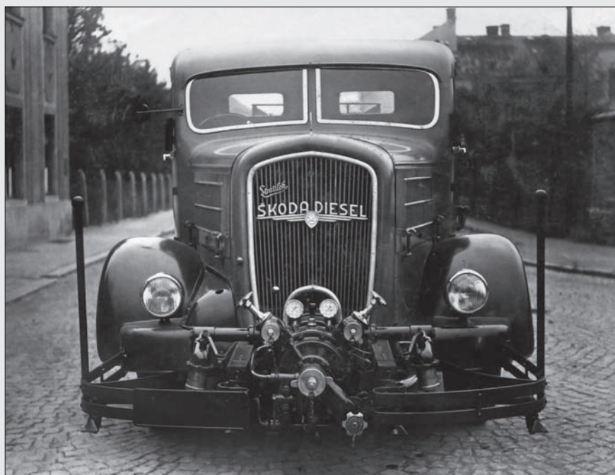
Automobil na mytí a čištění komunikací firmy Stratílek na podvozku Škoda 406 Diesel z druhé poloviny 30. let
