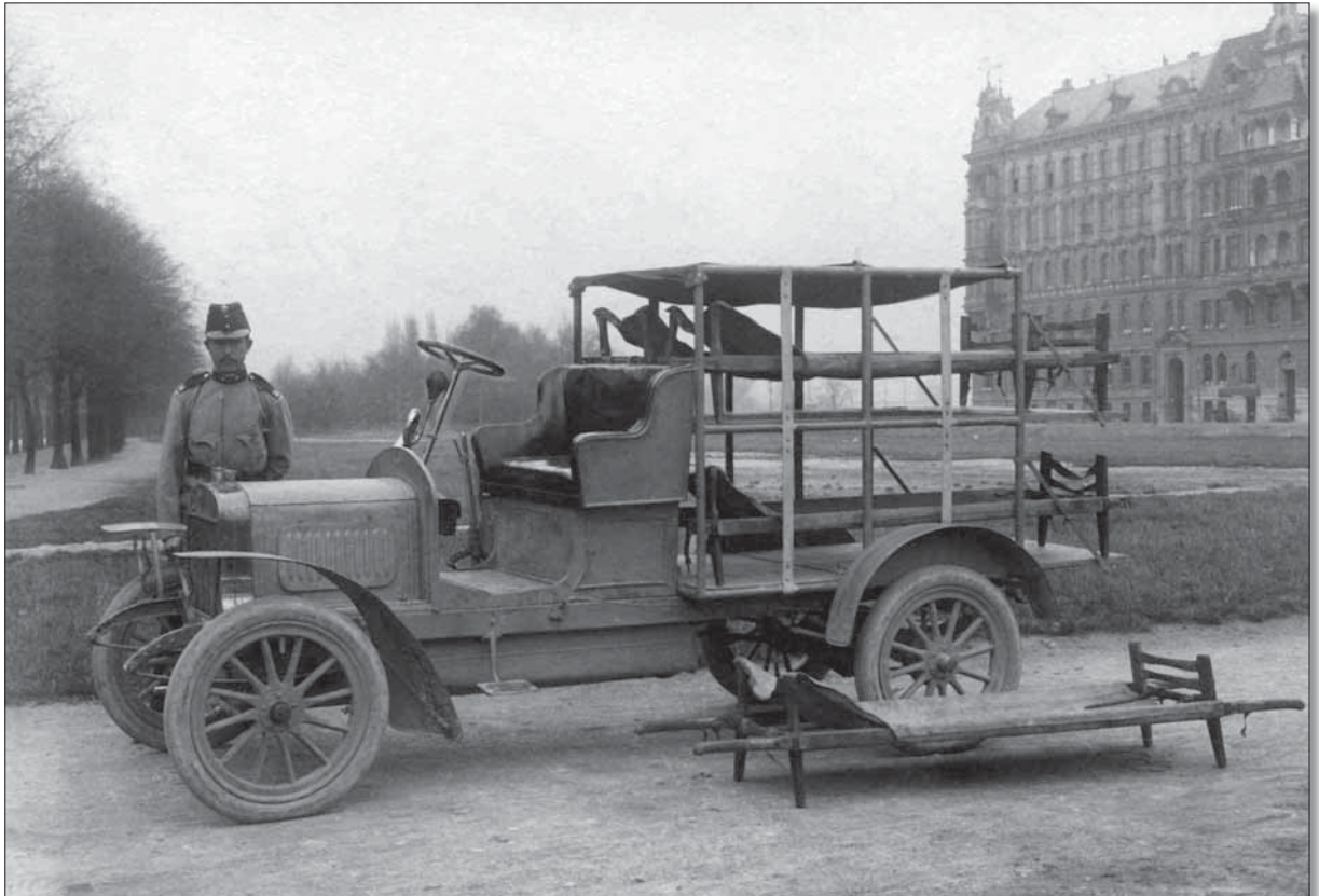
Vojenský sanitní automobil na podvozku Laurin & Klement typ C 10/12 HP z roku 1906 (Archiv společnosti ŠKODA AUTO)
