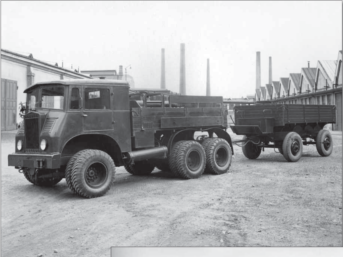
Střední tahač Škoda 6STP6-L s dvoumontáží na všech kolech (Státní oblastní archiv v Plzni)
