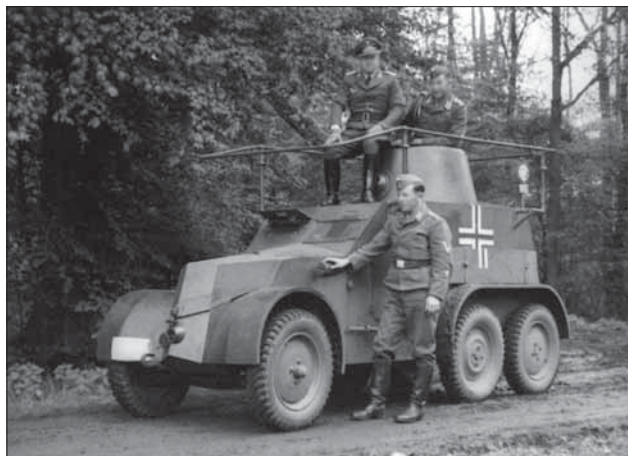
Obrněný radiovůz Tatra OA vz. 30 na podvozku Tatry 72 (Sbírka Henry Hoppe)
