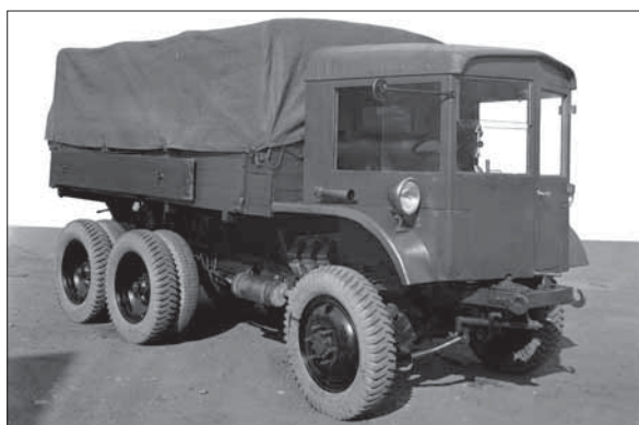
Tahač Škoda 6MTP6 z roku 1934 měl pohon všech kol. (Státní oblastní archiv v Plzni)
