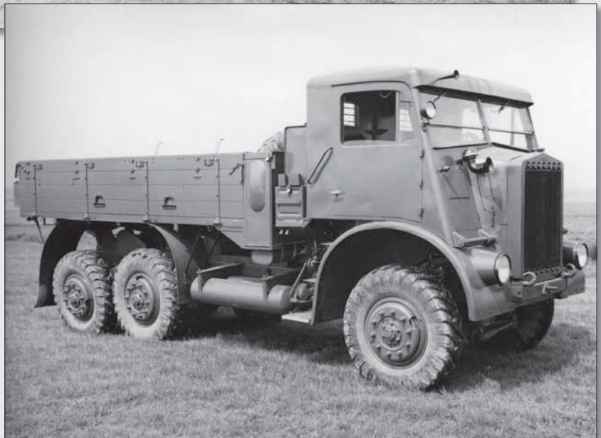
Škoda 6STP6L-D se vznětovým motorem z roku 1937 (Státní oblastní archiv v Plzni)
