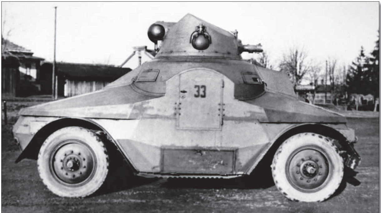
Těžký obrněný automobil Škoda PA-III (OA vz. 27) se silničními pneumatikami (Sbírka Daniel P. Minář)
