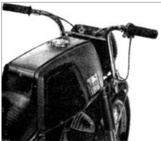
Obr. 30: Nádrž a uchycení řídítek typu Jawa 350-633
