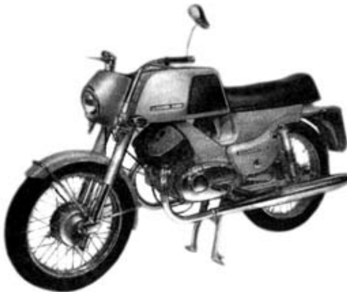
Obr. 25: Jawa 350 typ 633-01 s kolébkovým rámem
