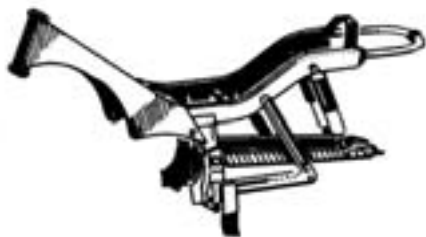
Obr. 28: Kolébkový rám páteřového typu motocyklu Jawa 350-633
