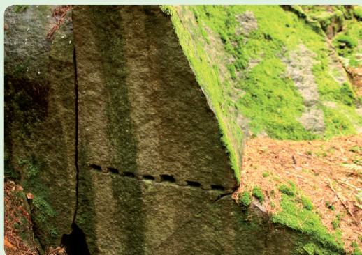
▲ Stopy po rozpojování kamenných bloků pomocí klínů bez použití trhaviny
