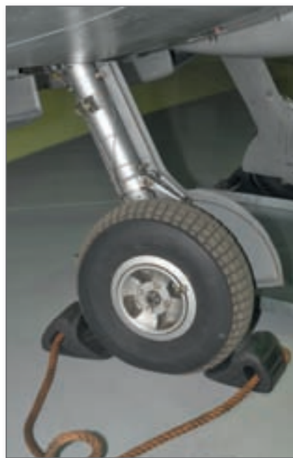
Disky podvozkových kol jsou pozdějšího provedení se čtyřmi odlehčovacími otvory.
