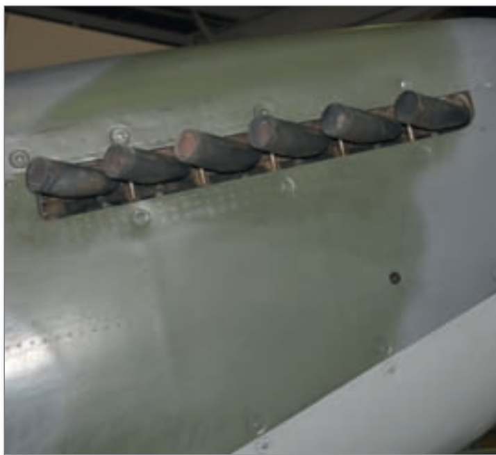
V protikladu k Mk VIII je Spitfire Mk XVIe vybaven kulatými ústími výfuků.
